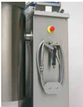
Frontmonteret slangeoprul og udtag på toppen af søjlen.
